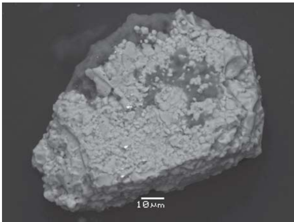
Рис. 4. Агрегат зерен \text{FeS}_2 с включениями Мо или (\text{MoS}_2?)
