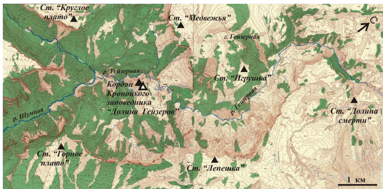
Рис. 2. Схема расстановки временных сейсмических станций в районе Долины Гейзеров в 2008 г. Использована топографическая карта района Долины Гейзеров, составленная НИИГАиК по заказу Института вулканологии ДВО РАН на основе стереотопографической съемки 1978 г.
