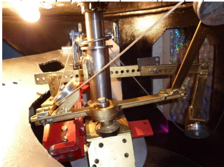
Рис. 6. Работа многофункционального рычага при воздействии на него Силой F_2 и поиск прохождения - соединения механизмов тросиком. см. Рис. 5
