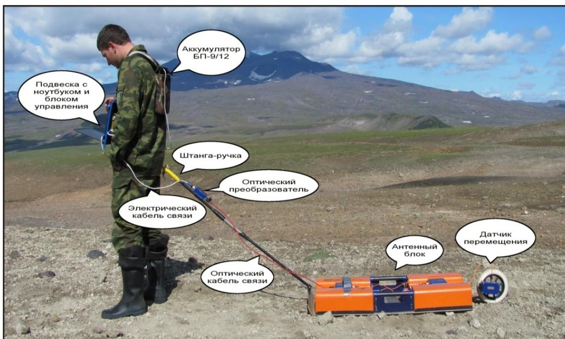
Рис. 2. Состав прибора георадар «ОКО-250».
