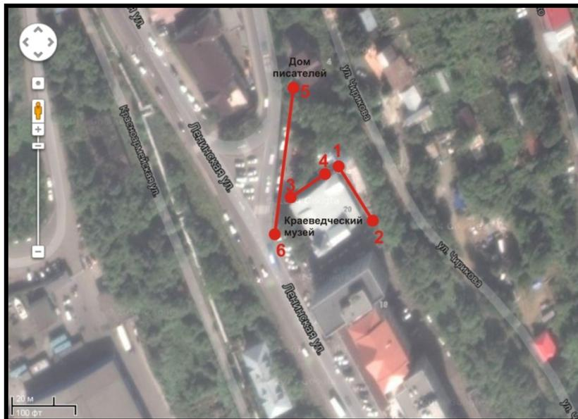
Рис. 5. Схема расположения георадиолокационных профилей. Условные обозначения: 1-2 – профиль 1 (36 м); 3-4 – профиль 2 (29 м); 5-6 – профиль 3 (57 м). Космический снимок Image Landsat, Data SIO, NOAA, U.S. Navy, NGA, GEBCO [www.earth.google.com](http://www.earth.google.com)).
