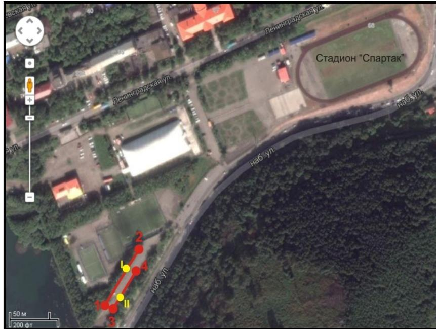
Рис. 7. Схема расположения георадиолокационных профилей. Условные обозначения: 1-2 – профиль 1 (52 м); 3-4 – профиль 2 (39 м); I – скважина С-5329/15; II – скважина С-5332/20. Космический снимок Image Landsat, Data SIO, NOAA, U.S. Navy, NGA, GEBCO [www.earth.google.com](http://www.earth.google.com).
