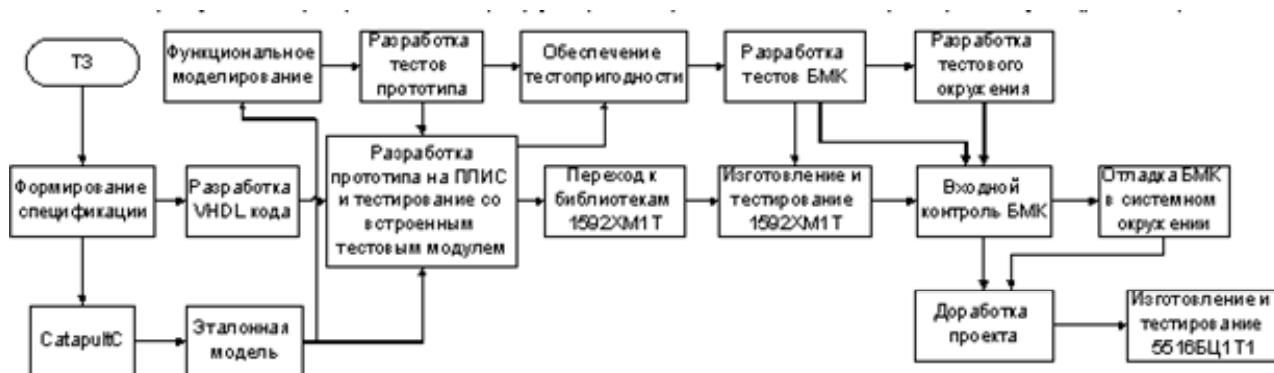
Рис. 2. Разработанный маршрут проектирования генератора синуса
