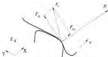
Рис. 1. Силы, действующие на наружное колесо в кривой
