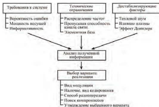
Рисунок 1 – Модель процесса разработки системы передачи ТМИ изделий РТ
