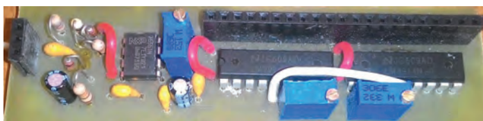
Рис.5. Плата преобразователя с установленными элементами
