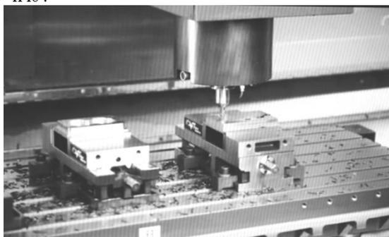
Рис. 1. Множественная обработка на станке с ЧПУ
