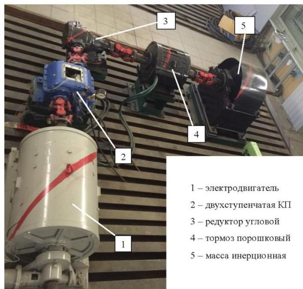
Рис. 2. Стенд для исследования процесса переключения передач в КП
