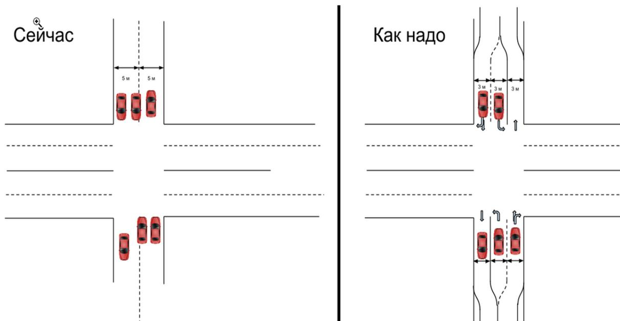
Рис. 3. Модель перекрестка до и после модернизации
