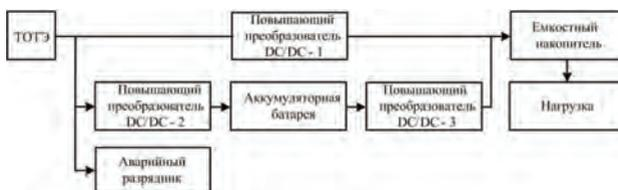
Рис. 1. Принципиальная схема силовой части преобразователей DC / DC
