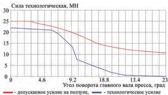
Рис. 3 – Допускаемые усилия на ползуне прессы модели К8544
