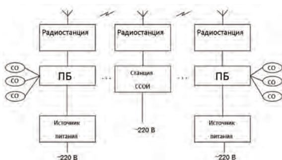
Рисунок 1 – Структурная схема организации электропитания ССОИ радиальной связью светодиодов.
