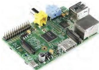
Рисунок 2 - Raspberry Pi Model B
