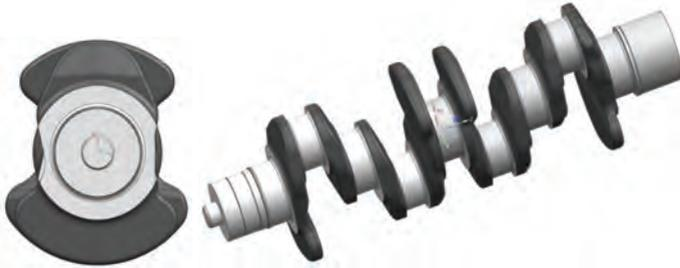
Рис. 2. Пример вала Р4. Тёмно - серым цветом обозначены необработываемые поверхности, светло - серым – обрабатываемые.
