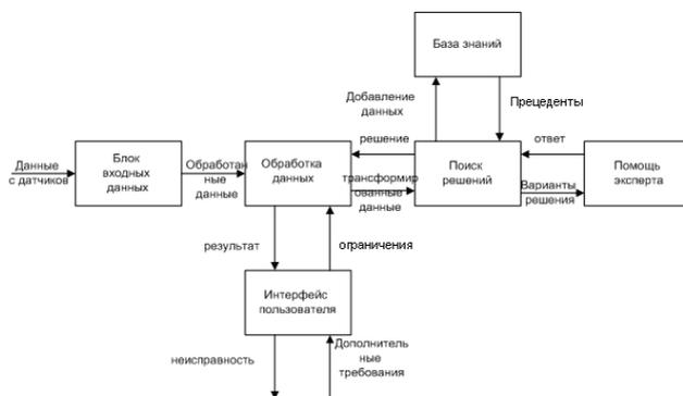
Рисунок 1. Архитектура СПДР диагностики ДВС
