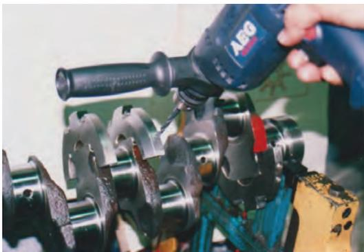
Рис.4. Корректировка неуравновешенности коленвала сверлением отверстий.
