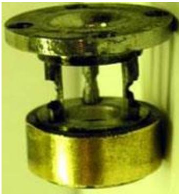
**Рис. 4.** Изображение выходного узла с тремя поврежденными обратными токопроводами после проведения эксперимента.
