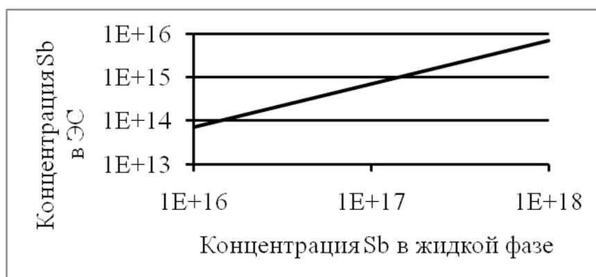
**Рис. 3** Зависимость концентрации Sb в ЭС от ее концентрации в жидкой фазе
