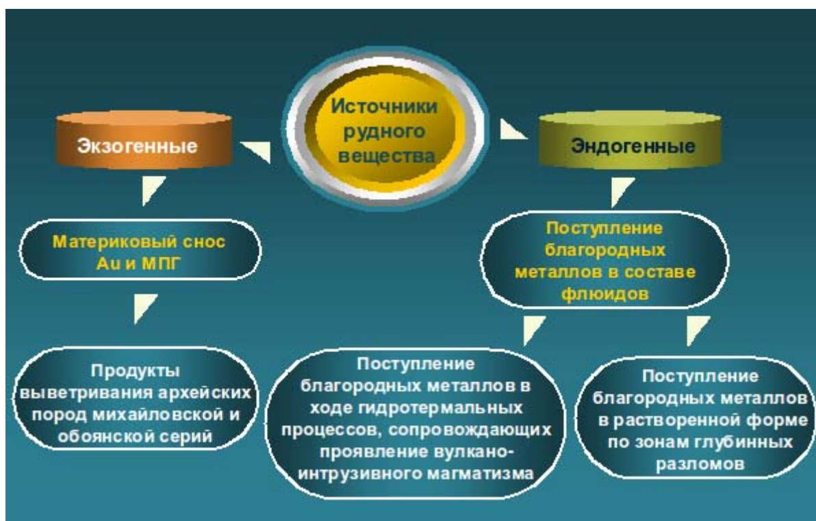
Рис. 9. Источники поступления рудного вещества при формировании благородно-металльного оруденения в межрудных сланцах курской серии (на примере Оскольского железорудного месторождения; по В.С. Кузнецову).
