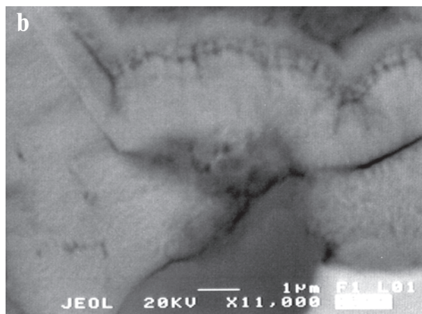
Фоссилизированные цианобактерии марганцевых руд кор выветривания: а — разрез чехлов цианобактерий; б — волокнистые наноструктуры оксидов марганца
