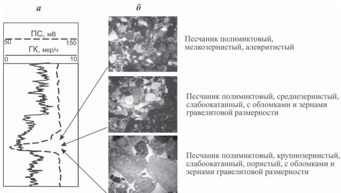
Каротажная (а) и петрографическая (б) характеристика русловых фаций
