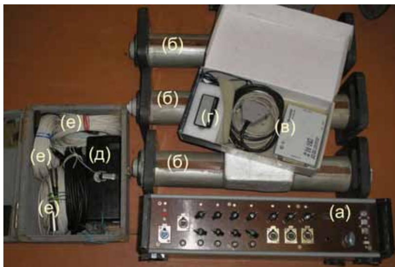
Рис. 1. Внешний вид станции. Измерительный блок – (а), индукционные датчики – (б), АЦП и фидера к нему – (в), GPS-приемник VT-359 – (г), фидера электрических каналов – (д), фидера магнитных индукционных датчиков – (е).
