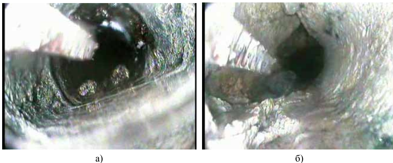
Рис. 5. Стоп-кадры нарушенных зон исследованных скважин ГП-38 (а) и ГП-3 (б) на глубинах 33 и 28 метров соответственно.
