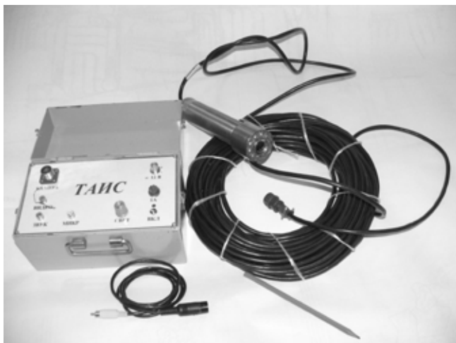
Рис. 3. Комплекс телевизионного контроля скважин.
