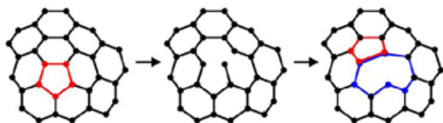
Рис. 3. Образование дислокации (синее) со смещением пентагона (красное).
