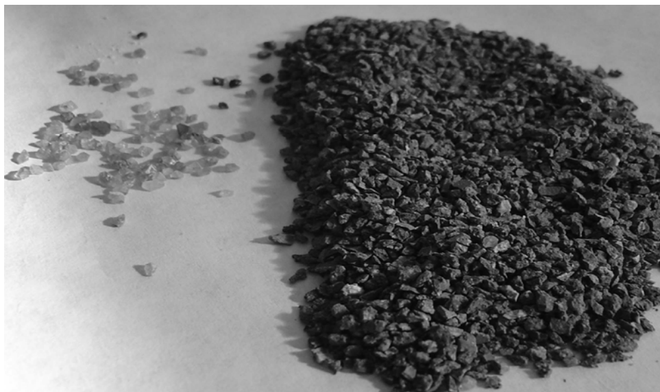
Рис. 4. Дезинтеграция кимберлита под влиянием циклов замораживания-оттаивания
