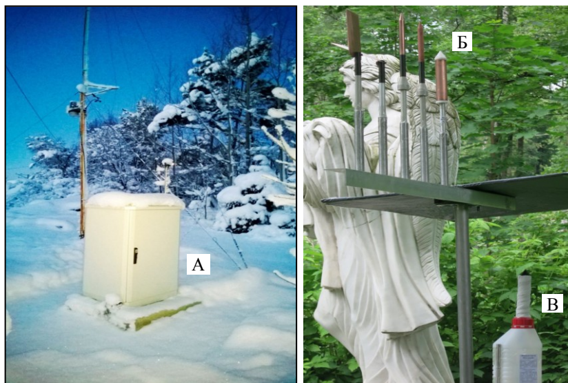
Рис. 2. Устройства для мониторинга коррозионной активности воздуха: А – станция «Скат»; Б – медные индикаторы коррозии, В – «мокрая свеча» для определения скорости выпадения хлор-ионов.
