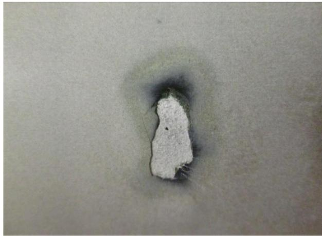
Рис.1. Дефекты на поверхности изделия из высокотвердой керамики после шлифования алмазным кругом
