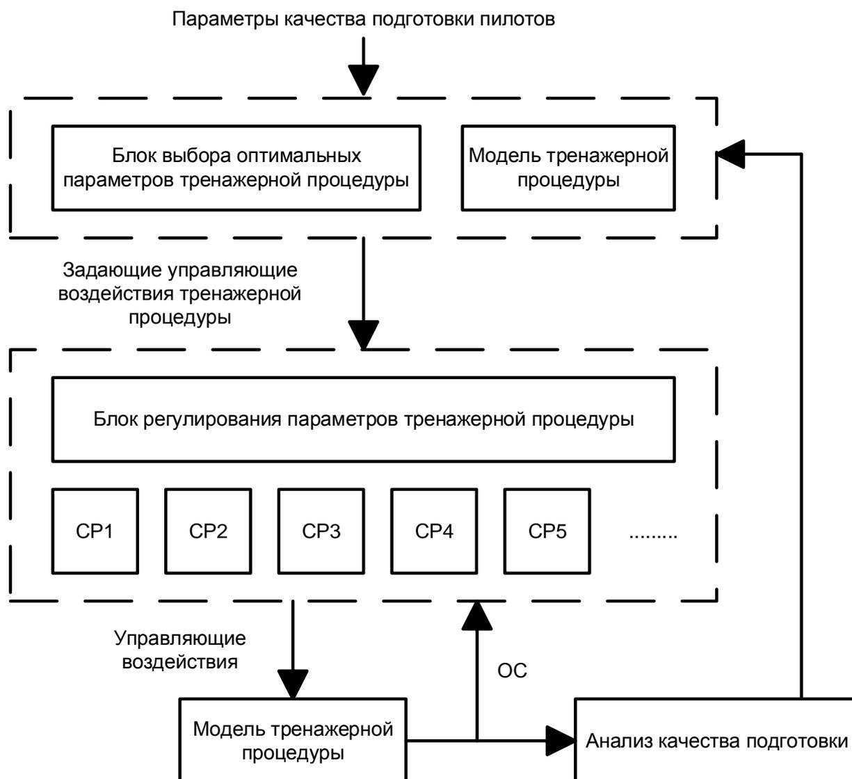
Рис.1. Структурная схема синтеза управляющего воздействия
