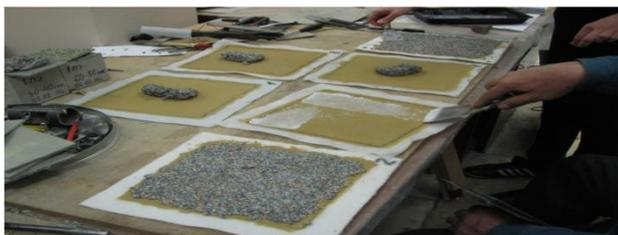
Рис.1. Изготовление образцов декоративного ковра с применением каменной крошки
