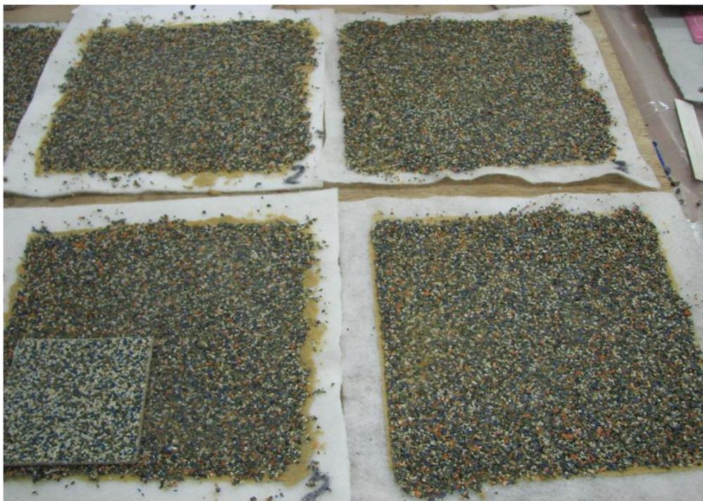
Рис.2. Изготовленные образцы декоративных ковров с применением мраморной крошки на тканевой основе
