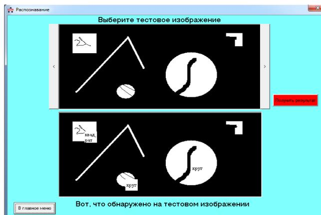
Рис.3. Распознавание при неточной бинаризации и вводе дополнительных фигур
