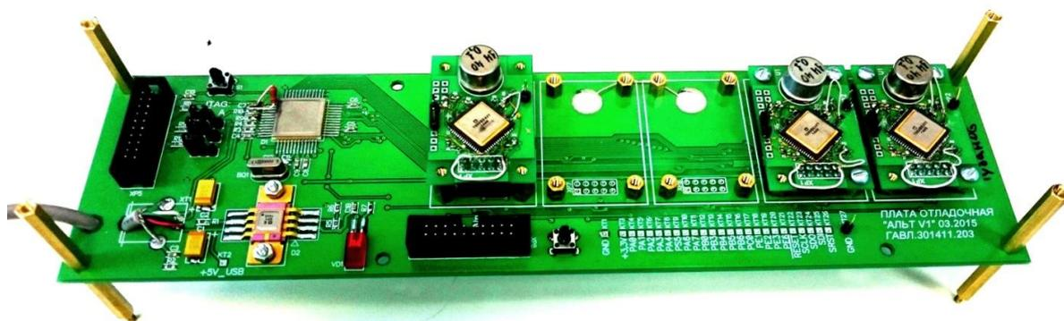
Рис.2. Внешний вид программатора
