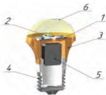
Она состоит из светодиодного модуля, выполненного в виде платы с алюминиевым основанием, на котором с помощью ручного метода поверхностного монтажа установлены светодиоды типа «эмиттер» (2) с заданной суммарной мощностью и и прикреплённой к светодиодному модулю осветительной арматуры, выполненной в виде теплорассеивающего радиатора (3),
