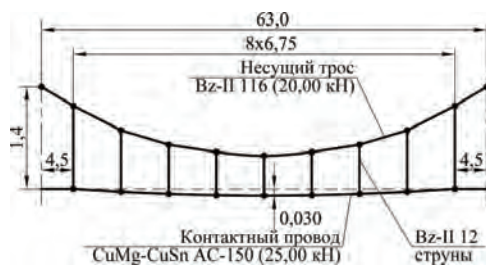
Рис. 2. Схема пролета современной контактной подвески ВСМ Франции
