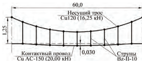
Рис. 4. Схема пролета контактной подвески ВСМ Италии
