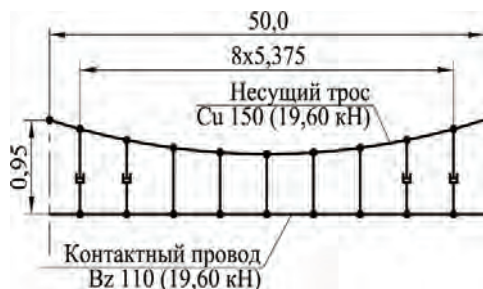
Рис. 1. Схема пролета современной одинарной контактной подвески ВСМ Японии с демпфирующими струнами
