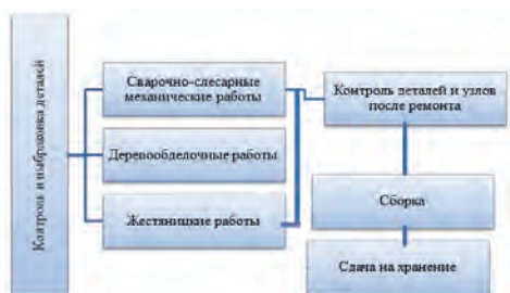
Рис.2. Технологическая схема ремонта сельскохозяйственных машин
