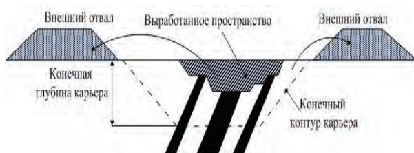
Рис. 1. Принципиальная схема развития рабочей зоны угольного разреза.
