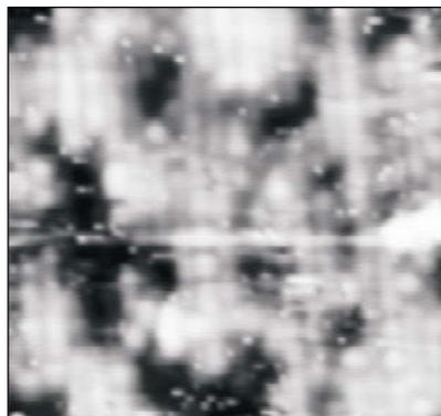
Рис. 15. СТМ-изображения GaAs(001)- $4 \times 1$ -I ( $\theta \approx 0.7$ ),  $95 \times 135 \text{ \AA}^2$ ,  $U_s = 2.8 \text{ В}$
