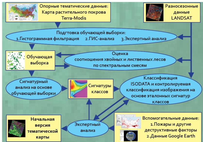
Рисунок 6 – Блок-схема тематической обработки временных серий спутниковых изображений
