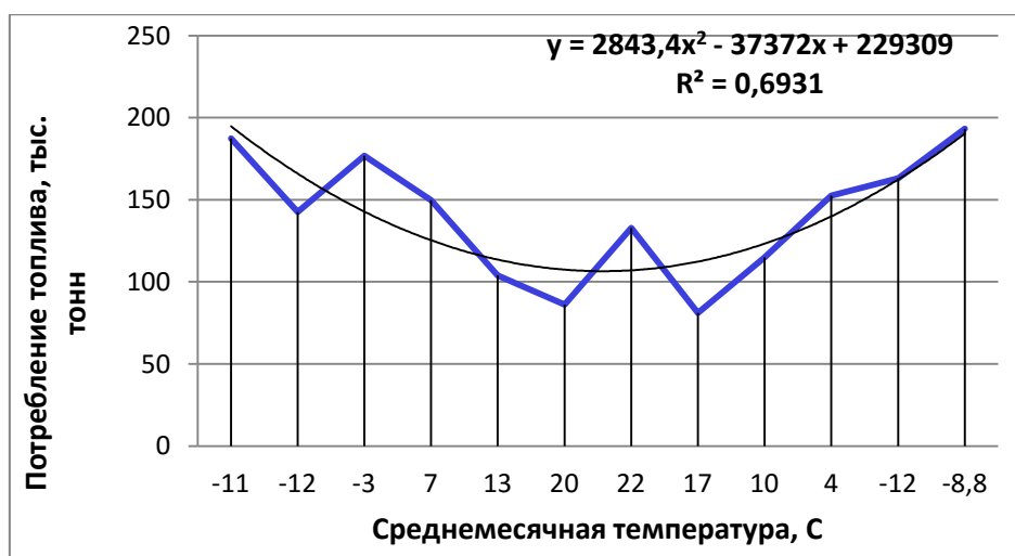
Рис. 2 – Связь потребления топлива (угля) с температурой среды
