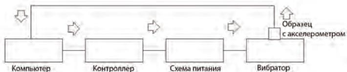
Рис. 1. Структурная схема вибростенда.
