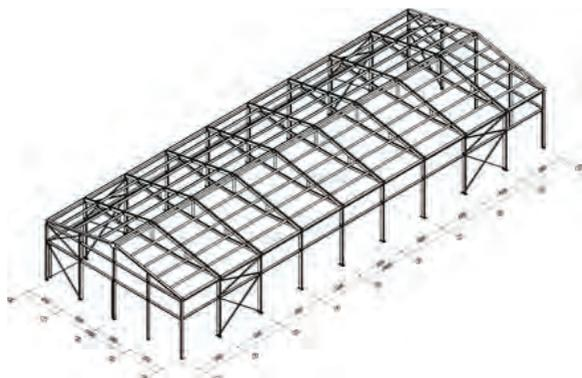
**Рисунок 3.** Схема несущего каркаса здания выполненного из холодногнутых оцинкованных строительных профилей
