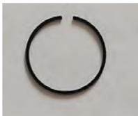
Рисунок 1. Поршневое кольцо после микродугового оксидирования
