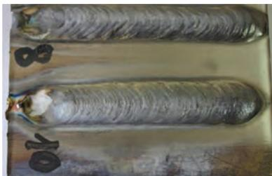
Рис.1 Внешний вид наплавленных валиков
