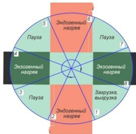
Рисунок 2 – Схема термообработки творожного сыря в СВЧ-индукционной установке: 1 – загрузка сырья, контроль и выгрузка готового изделия; 2 – эндогенный нагрев сыря; 3 – выравнивание температуры и влажности в сырье; 4 – экзогенный нагрев сыря; 5 – выравнивание температуры и влажности в сырье; 6 – повторный эндогенный нагрев; 7 – выравнивание температуры и влажности в сырье; 8 – повторный экзогенный нагрев сыря
