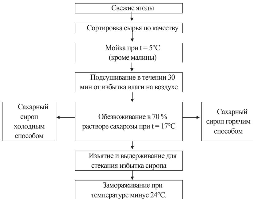
Рисунок 2. Схема переработки ягодного сырья.
