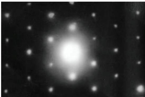
Рис.3. Микродифракция электронов от монокристаллической пленки теллура:  $T_{II} = 693 \text{ K}$ ,  $T_{II} = 293 \text{ K}$ .
