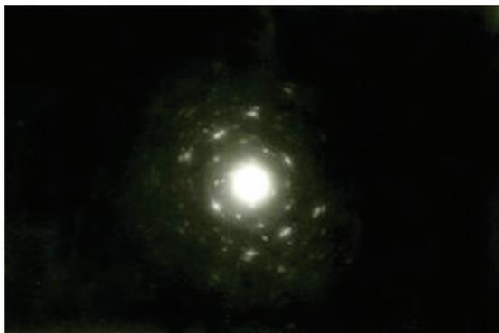
Рис.12. Электронограмма от пленки теллура, обладающей зеркально отражающей поверхностью.
