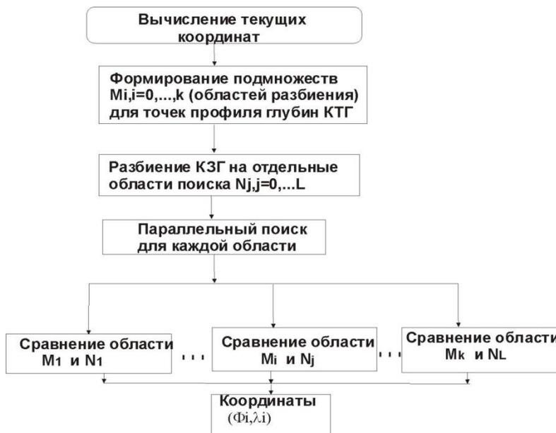
Рис. 2. Блок вычисления координат места судна по полю глубин
