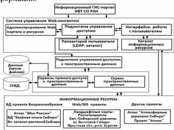
Рис. 1. Структура распределенной ГИС
