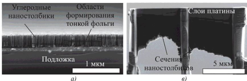
**Рис. 1.** Приготовление тонкой фольги со ступенчатым профилем при помощи ФИП: а) изображение во вторичных электронах углеродных наностолбиков и схема формирования из них тонкой фольги; б) изображение во вторичных электронах полученного образца.
