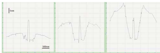
Рис. 3 Эволюция профиля рельефа углеродного осадка ; t = 10\text{мин} (а), 30\text{ мин} . (б), 60\text{мин} . (в).
