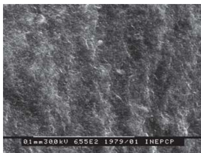
Рис. 2. СЭМ изображения изломов образцов композитов ПЭ/ООБ с содержанием ООБ a) 10%об. и б) 40%об.
