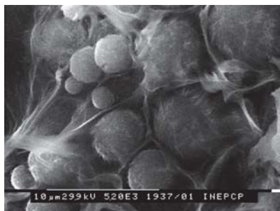
Рис. 3. СЭМ изображения различных участков изломов образца композита ПЭ/ООБ с содержанием ООБ 40%об.
