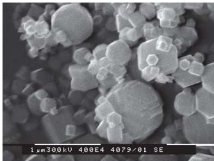
Рис. 2 СЭМ изображения частиц Zn, полученных при давлении Ar 0.25 ата.
