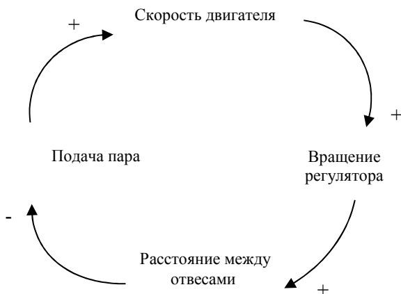
Рис. 4-5. Петля обратной связи для центробежного регулятора
