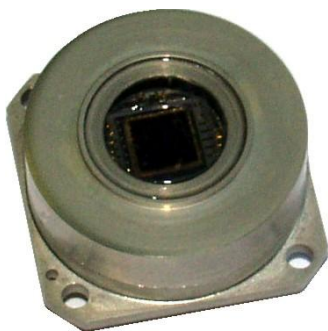
Рис. 1. МФПУ 320x256 на InGaAs/InP
