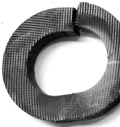
Рис. 3. Вид типового разрушения кольцевого образца
