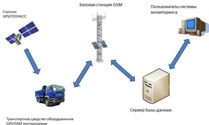
Рис.1 – Принцип работы системы мониторинга [2]
