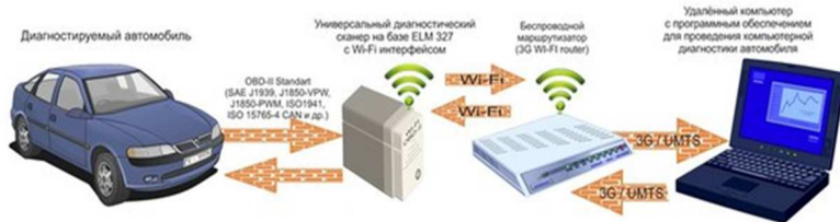
Рисунок 2 – Схема взаимодействия автомобиль-адаптер-маршрутизатор-компьютер
