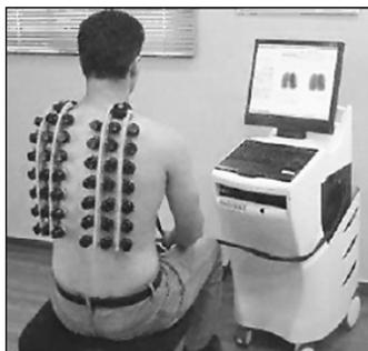
**Рис. 4.** Система для визуализации дыхательных шумов. Массив пьезоэлектрических микрофонов закрепляется на спине обследуемого с помощью присосок, сила присасывания которых регулируется с компьютера. Специальная программа обработки звуковых сигналов преобразует информацию, полученную со всех микрофонов, в чёрно-белые динамические изображения лёгких (из работы [96])
