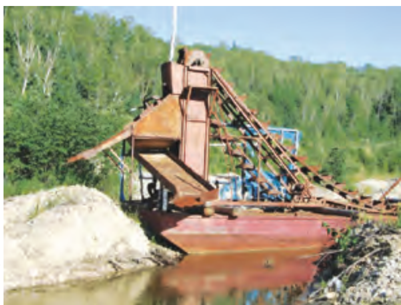
Рис. 2.7. Китайская импортная драга на р. Березовой в ЕАО
