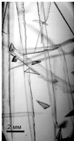
Рис. 2.2.9. Фрагмент гелевой колонки в пробирке с кристаллами брушита двух морфологических типов
