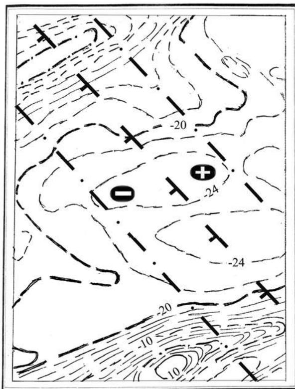
Рис. 115. Схема аномалий силы тяжести. Лист Р-58-XXIV. Изоаномалы проведены через 5 мГл
