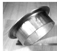
Рис. 4. Раскатанный фланец из трубной заготовки диаметром 219,1 мм: толщина стенки 7,8 мм, толщина фланца 9,4 мм, ширина фланца 38..39 мм, радиус перехода от трубной части к фланцевой R=12,7 мм, материал AISI 316 значительной механической обработке по торцевой и боковой поверхностям фланцевой части. Коэффициент использования металла при представленной технологии раскатки с многостадийной осадкой составляет около 95%.
