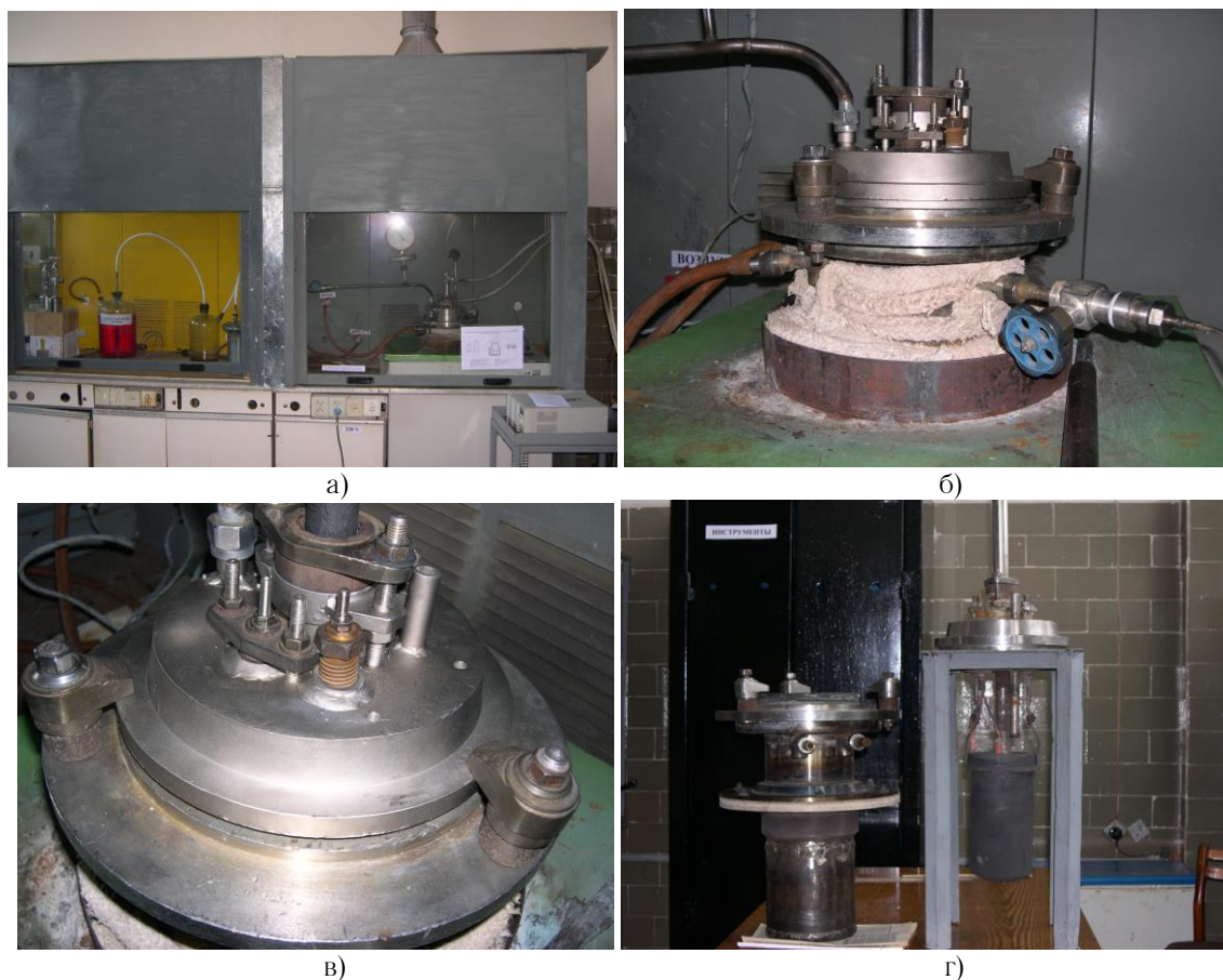
Рис. 2. Опытная электролитическая установка электролитического разложения тетрафторида титана.
