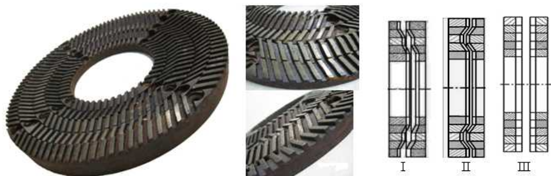
Рис. 1. Ножевая размалывающая гарнитура с пространственным расположением ножей в трех плоскостях XYZ: I – коническая полость размола; II – волнообразная полость размола; III – плоская полость размола
