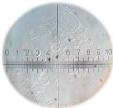
Рис. 2. Микрофотография раствора крахмала, клейстеризованного традиционным способом (нагрев до 95 °С)
