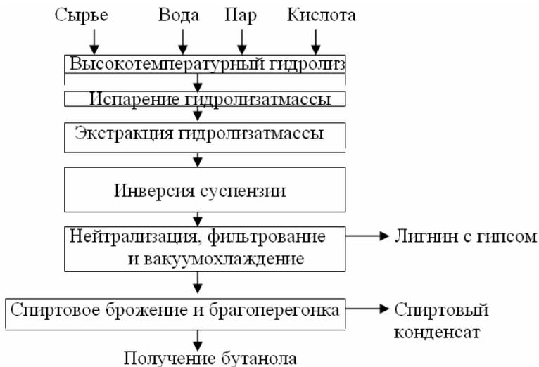
Рис. 2. Технологическая схема подготовки гидролизатмассы к биохимической переработке
