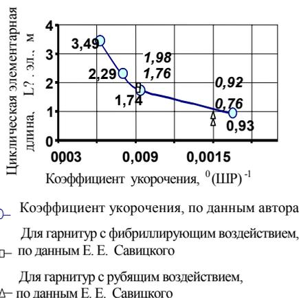
Рис. 3. Зависимость расчетного показателя циклической элементарной длины ( $L_{0,эл}$ ), от коэффициента укорочения
