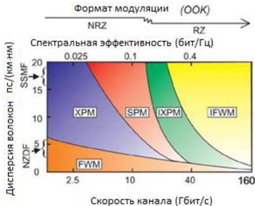
Рис. 10.8. Значимость внутриканальных и межканальных нелинейных воздействий на характеристики WDM системы связи с различными канальными скоростями. В высоко-скоростных системах связи и при дисперсии ( D > 10 пс/(нм·км)) наиболее значительное воздействие оказывают внутриканальная кросс-модуляция (iXPM) и внутриканальное ЧВС (iFWM).
