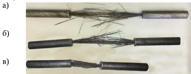
Рис. 3. Схемы разрушения опытных базальтопластиковых образцов с длиной рабочего участка: а) 240 мм (40d); б) 180 мм (30d); в) 90 мм (15d)
