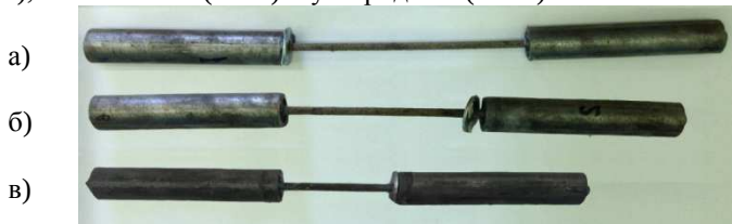
Рис. 2. Опытные образцы с длиной рабочего участка: а) 240 мм (40d); б) 180 мм (30d); в) 90 мм (15d)
