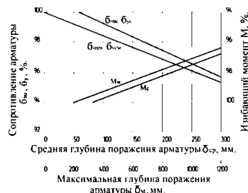
Рис. 1. Зависимости изменения величины несущей способности железобетонных балок и физико-механических характеристик арматуры класса А-III Ø14 мм от глубины коррозионного поражения арматуры
