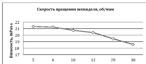
Рис. 2. Зависимость динамической вязкости раствора гидроксиэтилцеллюлозы 0,3% от скорости сдвига
