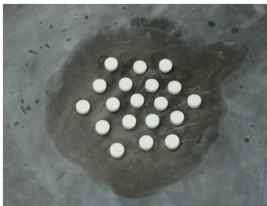
Рис.3. Схема расположения таблеток уротропина (гексаметилентетрамина) на подстилающей поверхности (режим №3).
