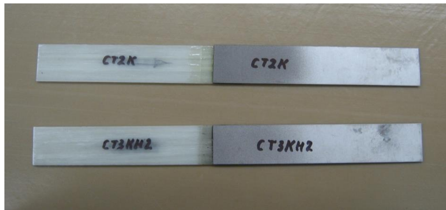
Рис.4. Фотоизображение образцов для испытаний клеевого соединения элементов из стеклопластика и титанового сплава.
