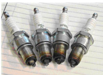
Рис.12. Отложения на свечах контрольного (слева) и испытуемого (справа) двигателей ВА3-2111 после 80 часов испытаний.
