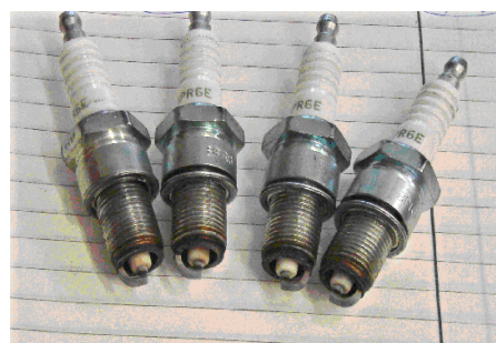
Рис.12. Отложения на свечах контрольного (слева) и испытуемого (справа) двигателей ВА3-2111 после 80 часов испытаний.
