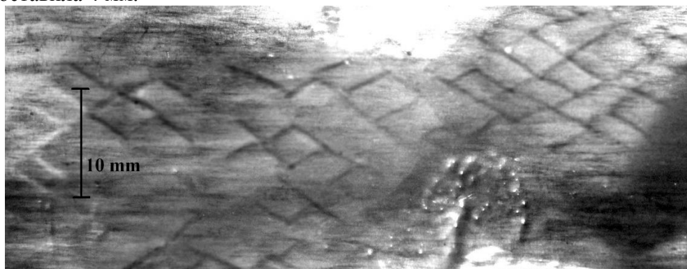
Рис.3. Фотография закопченной фольги, вынутой из измерительной секции. Видна ячейистая структура детонации.
