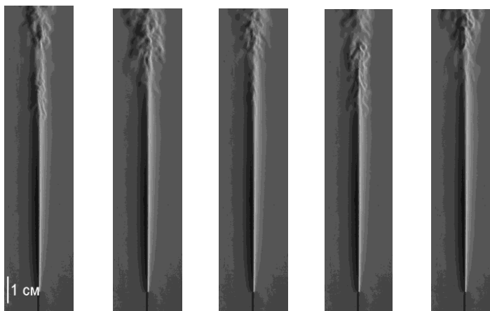
Рис.2. Теневые фотографии струи гелия ( V = 79 м/с, Re = 710 ) в различные моменты времени. Начальный диаметр струи d = 1 мм.
