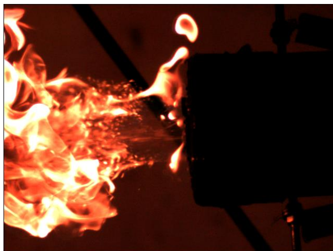
Рис.9. Горение «пористого» керосина с присадками гоафена, время задержки воспламенения \tau = 1,3 \cdot 10^{-2} сек
