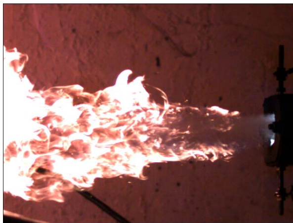
Рис.5. Горение «чистого» барботированного – пористого керосина. Скорость потока 15 м/с при выходе из камеры смешения. Время задержки воспламенения 2,5 мс
