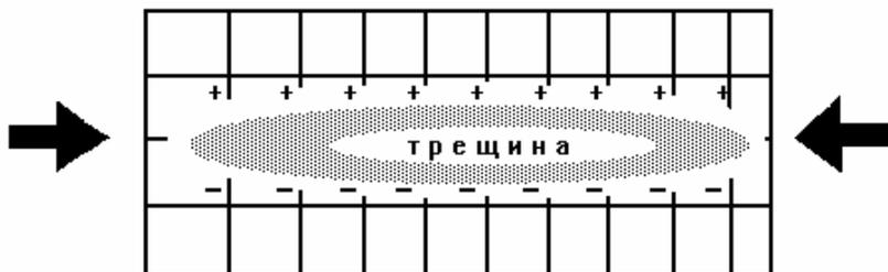
Рис. 2. Схема поляризации трещины в момент раскрытия за счет воздействия поперечной волны (стрелки).
