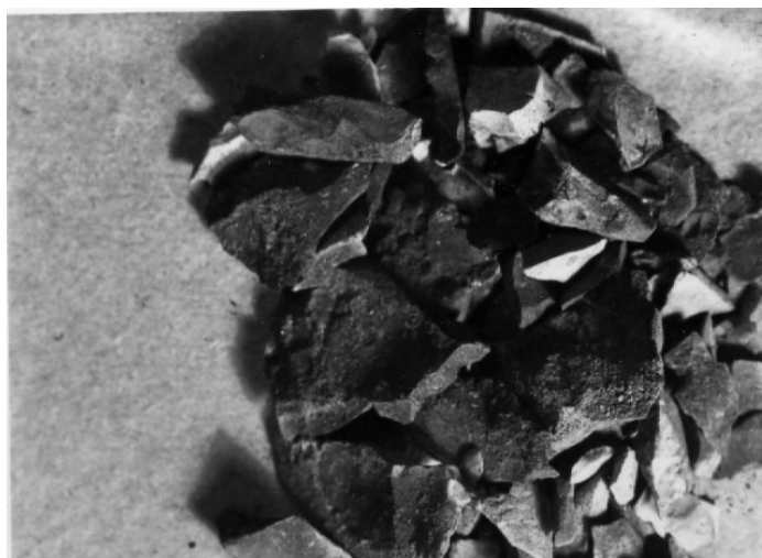
Рис.1. Характер разрушения шунгитовой породы месторождения Загогино (т.о. при 400 0 С).
