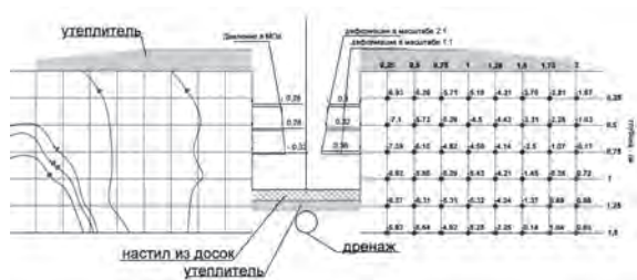
Рис. 3. Распределение температур, деформаций, давления в МПа по 2, 3, 4 от поверхности швеллера №22 на 05.02.2011. В правой части температура грунтов по термокосам, в левой части изотермы, отвечающие этой температуре.
