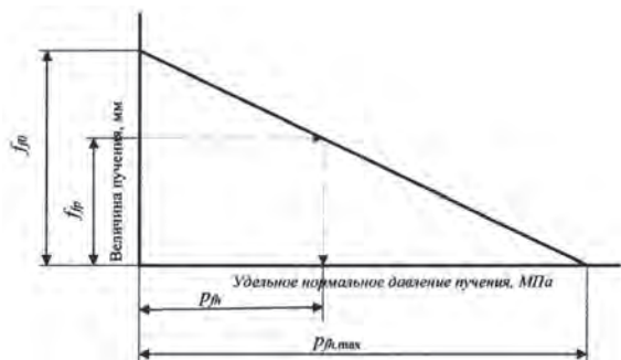
Рис. 1. Определение величины удельного давления морозного пучения p_{\text{р}} с учетом допустимого (возможного) перемещения сооружения на величину f_{\text{р}} (абсолютной деформации морозного пучения).
