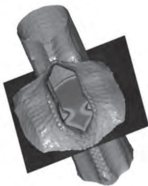
Рис. 3. Нулевая изотермическая поверхность со стороны вентканала и горизонтальное сечение температурного поля без отображения подземных конструкций.
