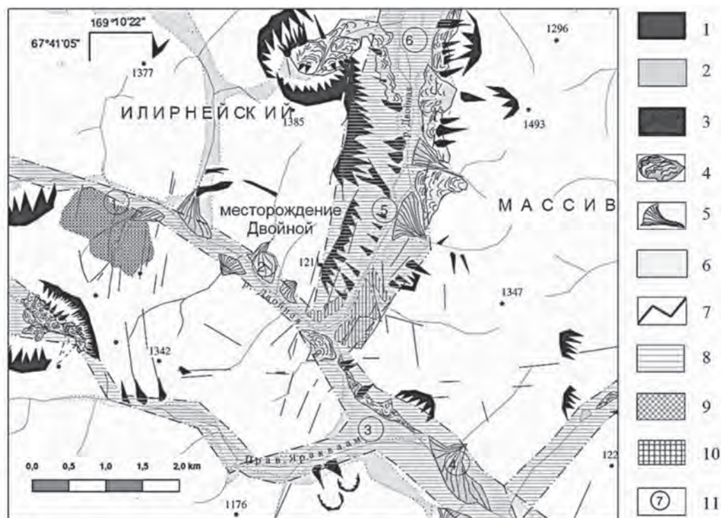
Рис. 3. Фрагмент схемы распространения негативных мерзлотно-гравитационных процессов на территории месторождения Двойное. 1 – ледниково-тектонические скалистые склоны с развитием обвально-осыпных и лавинных процессов; 2 – ледниковый и водно-ледниковый рельеф днищ долин; 3 – крупные осыпные конусы; 4 – каменные глетчеры; 5 – конусы пролювиально-селевого выноса; 6 – современные русла, поймы и наледные участки долин; 7 – открытые тектонические трещины; 8 - зоны дробления крупных разрывов; 9 – участки структурно-тектонического бедленда; 10- участки ледниково-тектонического бедленда; проектируемые и действующие строительные площадки.
