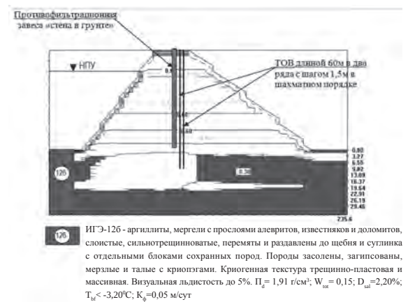
Рис. 2. Температура и кодировка грунта на начало расчета.
